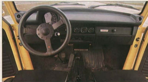
Für wichtige Zusatzinstrumente bleibt im Käfer-Armaturenbrett nur die Radio-Einbauöffnung
