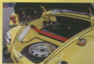
Eine Domstrebe im Kofferraum sorgt für zusätzliche Steifigkeit in Marnix' Renner
