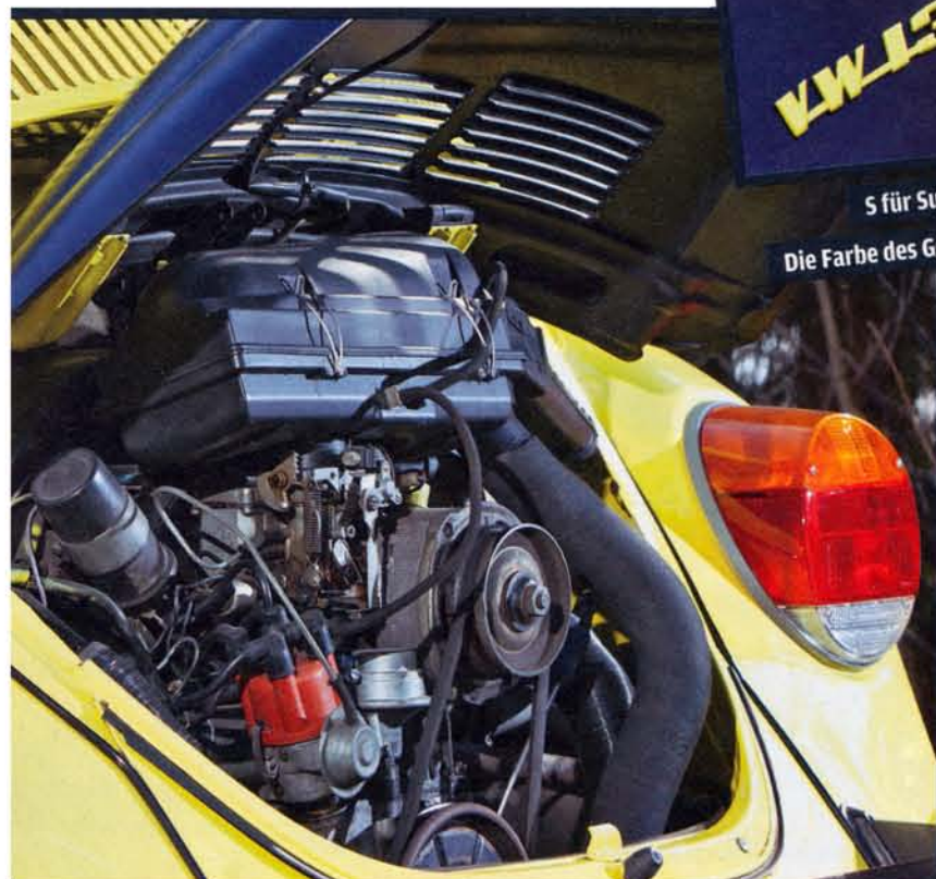
Doch, da glänzt originales Chrom am Gelbschwarzen Renner: Blinker und Scheinwerfer- ringe blieben unmattiert. Und auch der Motor gleicht dem Serien-1303: 50 PS aus 1,6 Liter Hubraum. VW genehmigte jedoch ganz offiziell bis zu 100 Tuning-PS
